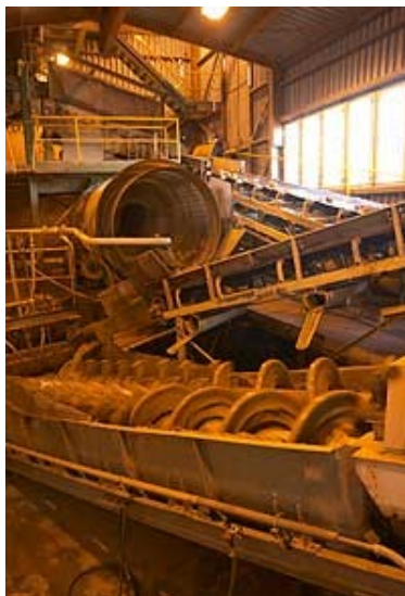
Třídění materiálu (granátonosných štěrků) z dolu na strojích.
